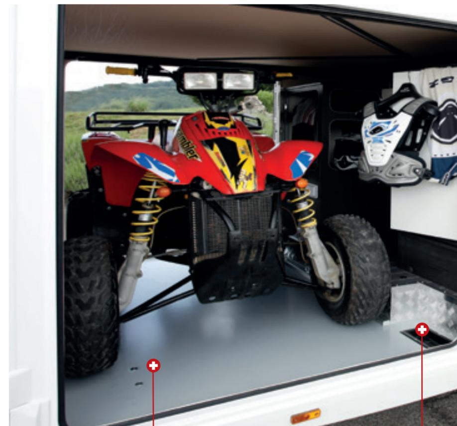
▲ Plancher avec protection en caoutchouc amovible.
