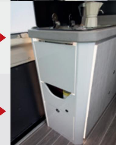
**Éclairage à leds**, sous les meubles pour éclairer le plan de travail de cuisine ou le salon, et sous le plan de travail lui-même pour éclairer l'intérieur des tiroirs. **LEDS** sur l'arrière de la cuisine, pour s'éclairer le soir quand la table est utilisée en extérieur.
