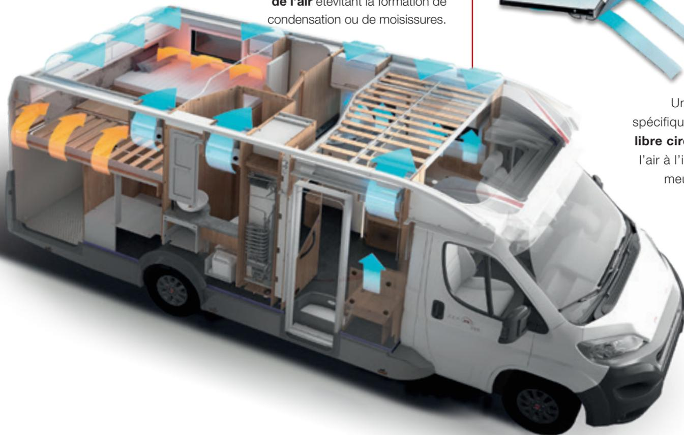
**Aération permanente** à l'intérieur de tous les placards. Les meubles hauts sont installés en laissant un espace avec la paroi du camping-car favorisant ainsi une **répartition uniforme de l'air** évitant la formation de condensation ou de moisissures.
