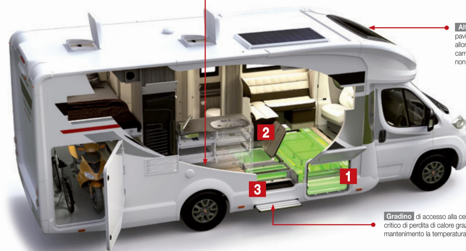
**Altezza** interna del doppio pavimento di 190 mm permette di allontanare il pianale cellula dalla carreggiata per un isolamento non solo termico ma anche acustico.
