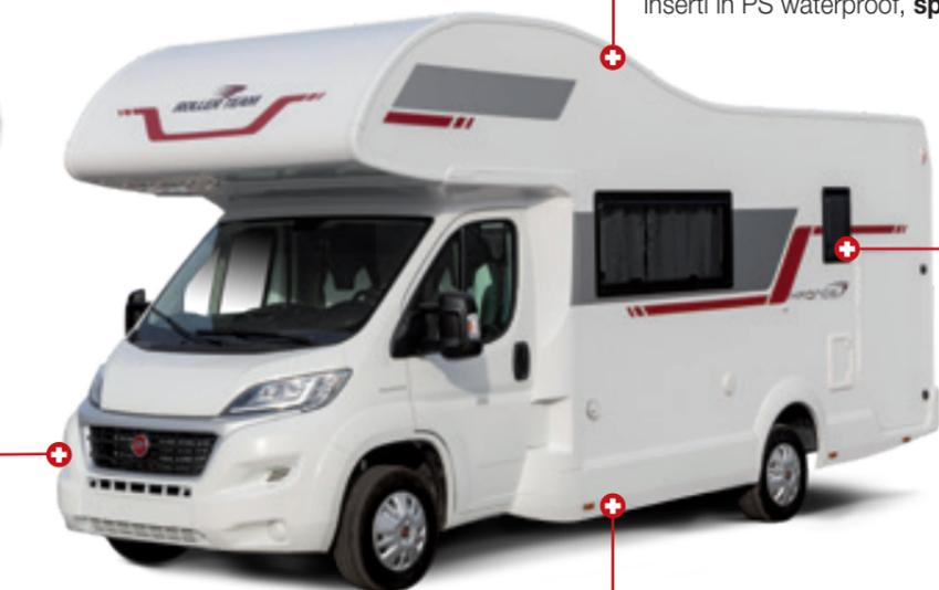
**Pavimento** copertura inferiore e superiore in vetroresina, pavimento in PS waterproof, protezione perimetrale in estruso e rivestimento interno PVC **spessore 54mm:**
